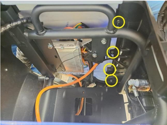
Irrota istuimen vasemmanpuoleisen alasivumuovin kiinnitysruuvit (ristipäämeisseli ph2).
